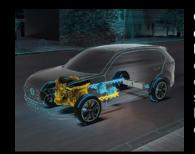
Como gran diferencial, gracias a la tecnología e:HEV, el motor de combustión carga el sistema manteniendo la tracción 100% eléctrica.
