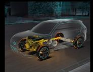
El modo de combustión se activa en velocidad crucero o en algunos momentos de aceleraciones moderadas, conectando el motor a las ruedas para mejorar la eficiencia y el consumo de combustible.
