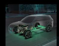
Gestiona la energía de forma inteligente, proporcionando la recarga automática a través del motor de combustión, que actúa como generador suministrando energía a las baterías.
